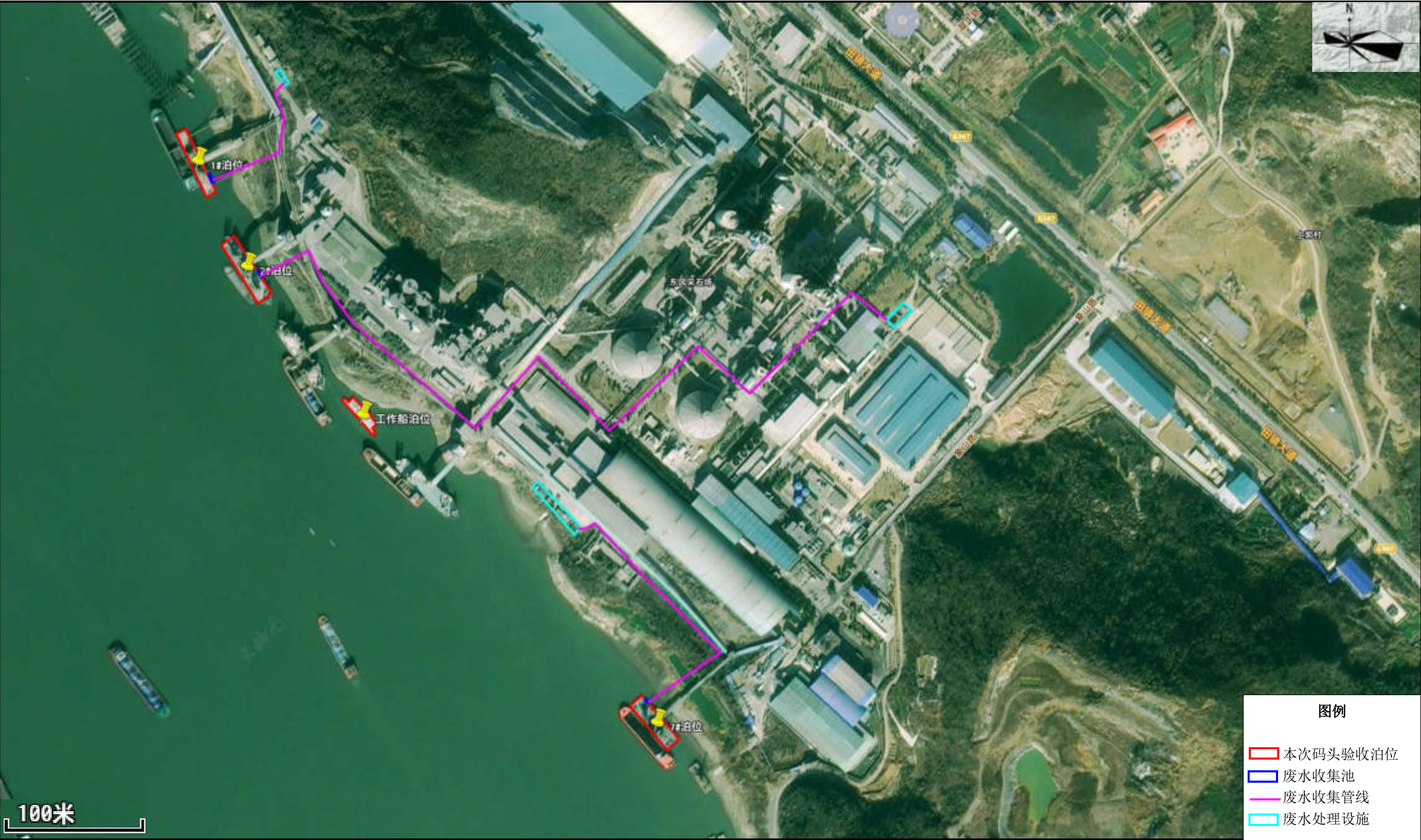
附图8 本次验收泊位废水收集管线图
